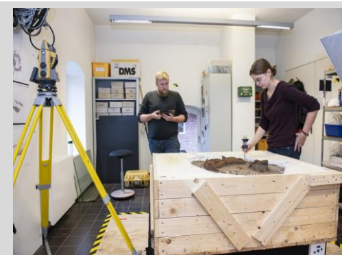
Abb. 3: Einmessung von Objekten mit dem Tachymeter
