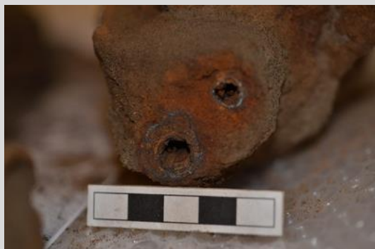
Schnitt durch ein Eisenobjekt vor der Restaurierung. Hohlkorrodiert mit innerer Korrosionsschicht, Magnetitschicht und Konglomeratschicht
